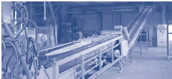
Extruderanlage mit Kühlband
